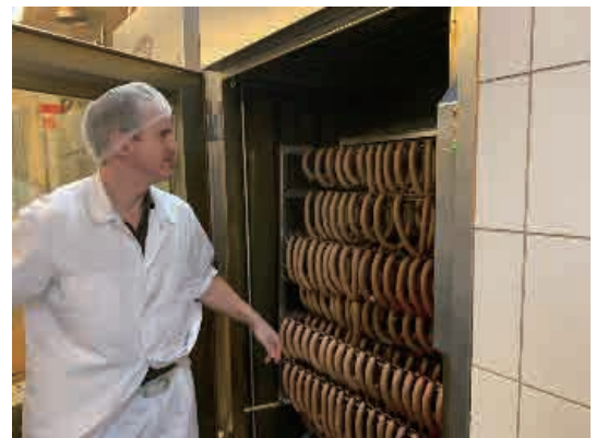
写真10 通常のフランクフルターの燻煙、燻煙材は西洋ブナ
